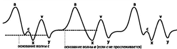
Рисунок 5.8. Выбор уровня установки трансдюсера и уровня регистрации абсолютного значения при оценке центрального венозного давления:
